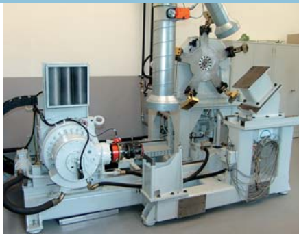
Prüfstand zum Test des Heckgetriebes
