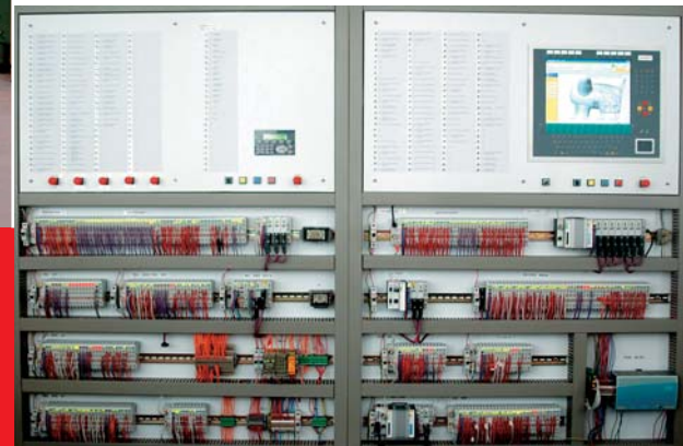
Der M5000-Teststand dient primär zur Zeitreduzierung für Funktionsprüfung und Inbetriebnahme sowie der Optimierung der Betriebsabläufe und Regelungsvorgänge.
