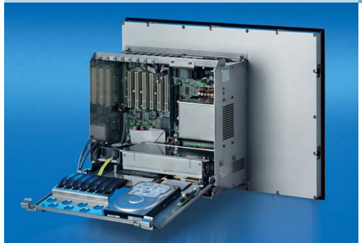
Der Panel-PC CP65xx verfügt über 6 PCI-Slots für den Einsatz von Feldbusinterfacekarten, Netzwerkkarten, Schnittstellenkarten, Modem oder ISDN-Adapter.
