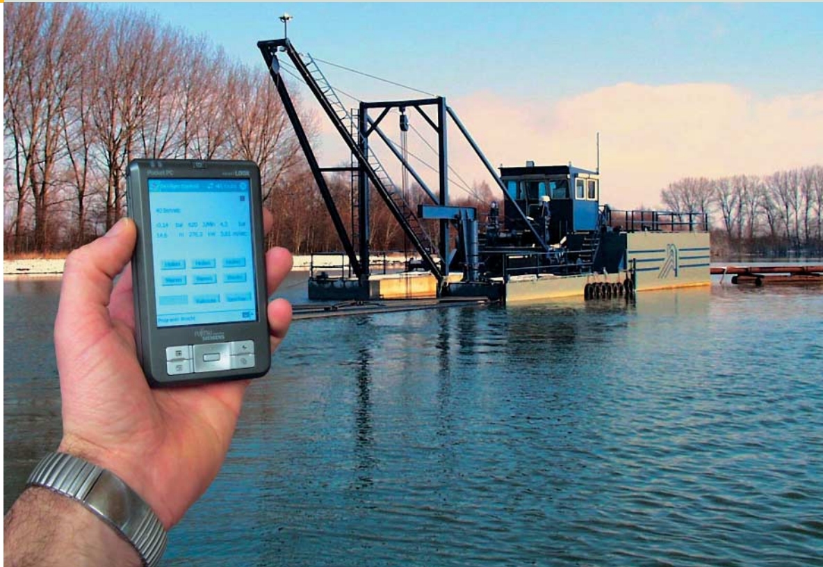
Das Saugschiff „Werthersechte“ lässt sich mit einem Handterminal fernsteuern.
