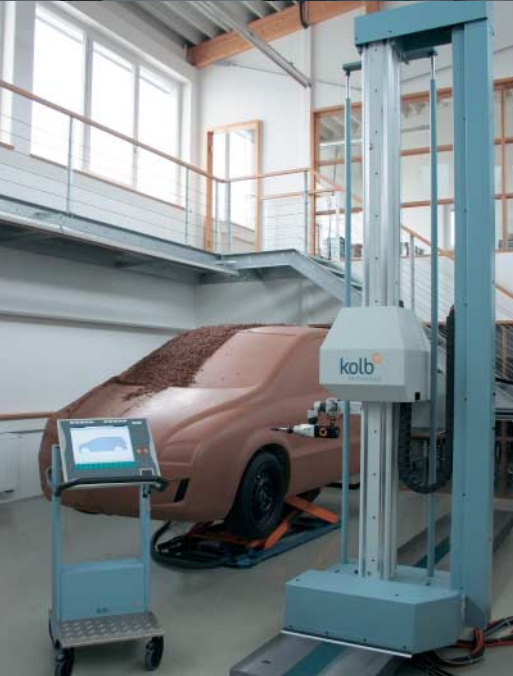
StudioLine3 CNC-Fräsmaschine im Kolb-Studio in Hengersberg mit 1:1 Clay-Modell und Beckhoff Control Panel auf mobilem Wagen.
