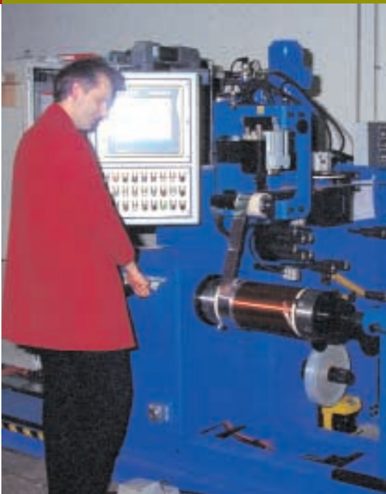
Christoph Müller, Leiter Elektrik und Software der Firma Tuboly bedient eine Trafo-Wickelmaschine. Der Betrieb ist weitgehend automatisiert.
