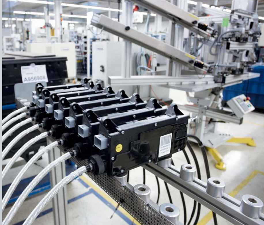
Die fertig kalibrierten EPBs in der Werkstückaufnahme. Anschließend wird als letztes Bauteil die fahrzeugmodellsspezifische Halterung an das Gehäuse montiert.
