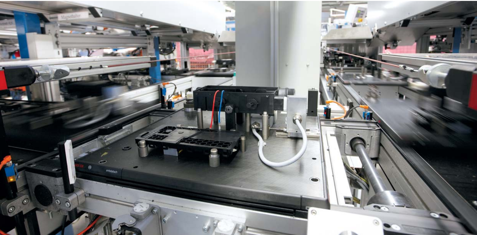
Auf dem Warenträger im Vordergrund ist der EPB-Gehäusedeckel zu sehen, dahinter das EPB-Gehäuse mit gerade eingebaute Platine. Im Anschluss an diesen Vorgang wird die Motor-Getriebeeinheit montiert.
