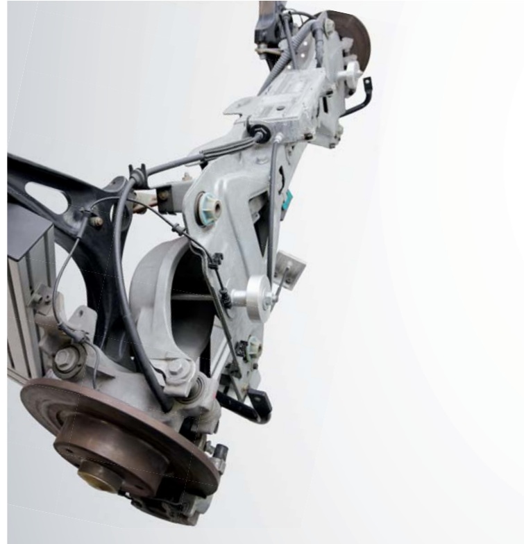
Elektronische Parkbremse (EPB) an einer Original-PKW-Hinterachse. Hier kann man auch die Seilverlegung, inklusive der eingehängten Bremsseile am Bremssattel sehen.
