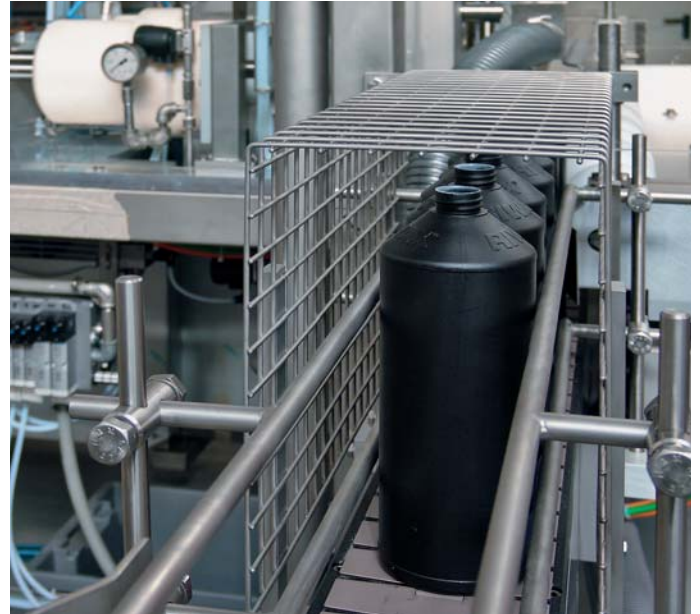
Mit der Polierpasten-Abfüllanlage werden gleichzeitig vier 1-kg-Gebinde befüllt. Der Füllvorgang erfolgt im 12-Sekunden-Takt.
