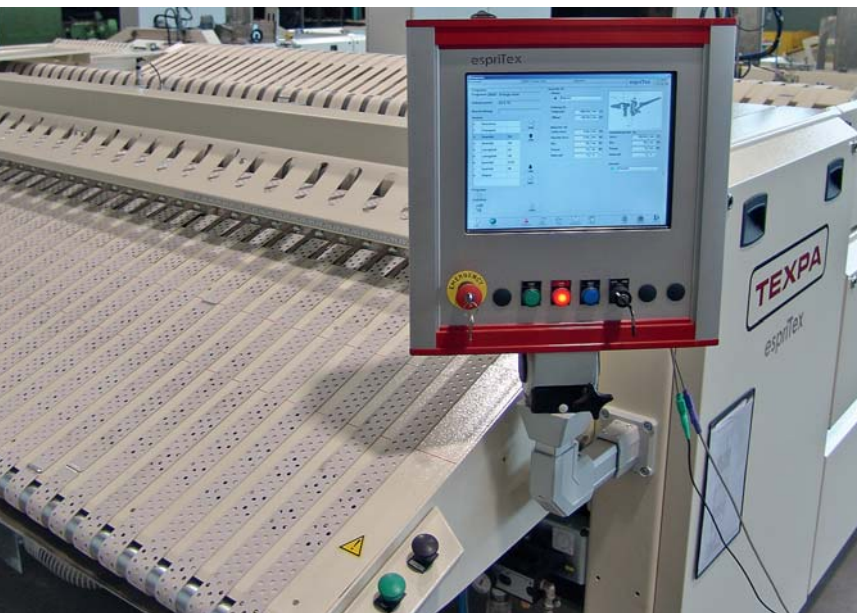
Modulare Faltschneidemaschine von espiTex mit einem Beckhoff-Touchscreen-Control-Panel in kundenspezifischer Ausführung als Bedieneinheit.
