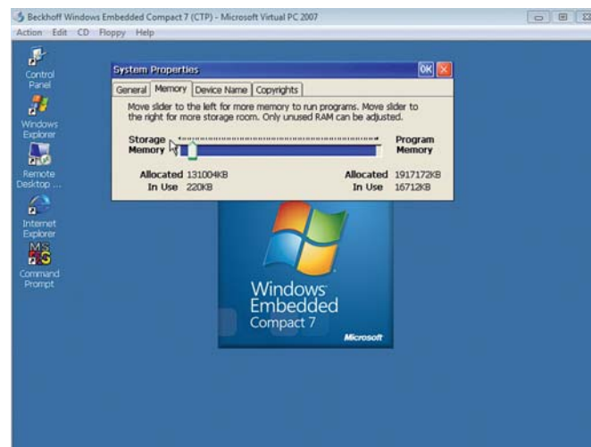
Das Compact-7-Betriebssystem läuft in einer Windows-Virtual-PC-Umgebung mit 2 GB verfügbarem Speicher.
