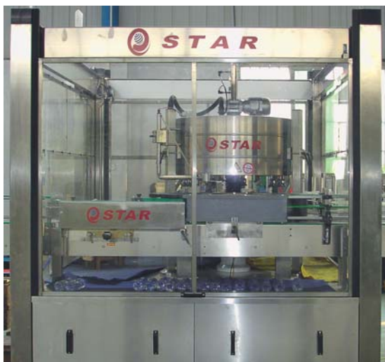
Zwischen 24.000 und 48.000 Flaschen pro Stunde können etikettiert werden.
