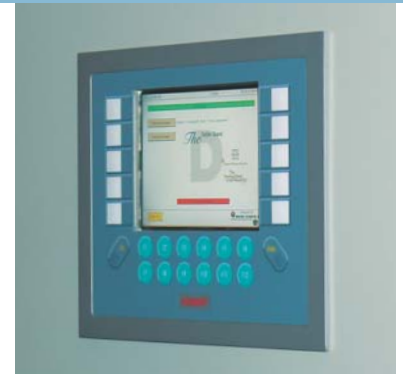
Beckhoff-Touchpanel in der Schaltschrankwand zur Visualisierung der Steuerung
