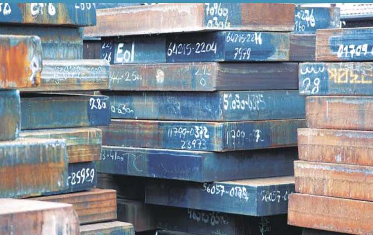
Das Lager für die aus Salzgitter angelieferten Rohmaterialien (Stranggussbrammen)
