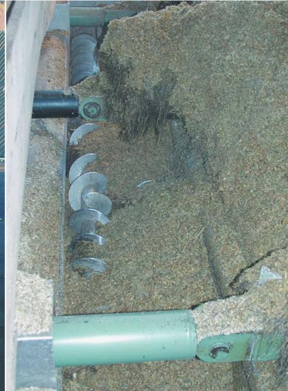
Zuführschnecken fördern die Biomasse in die Fermenter.
