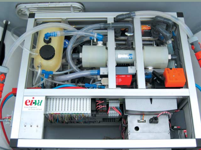
Brennstoffzelle mit BC9000 für die Prozesssteuerung.
